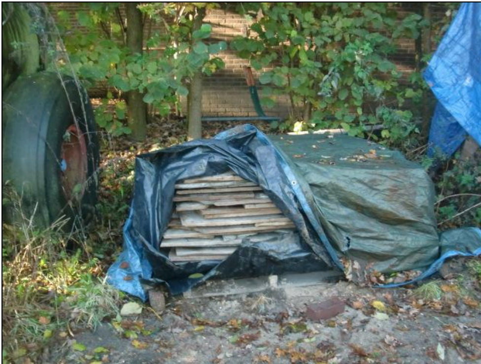
Foto 6, Erf achter materielschuur; AC plaatmateriaal op pallet Monster AMP002
