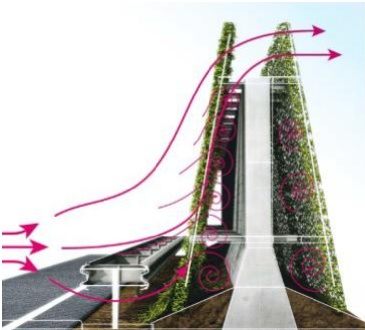
Figuur 18.2: Concept Wall4Life; groen scherm met luchtreinigend vermogen
