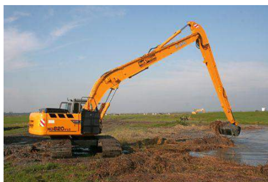
Figuur 5.11 Sloten schonen met een 'long-reach' kraan. <foto: Van Oostrum, 2009 / E. Wennekes-Slump>
